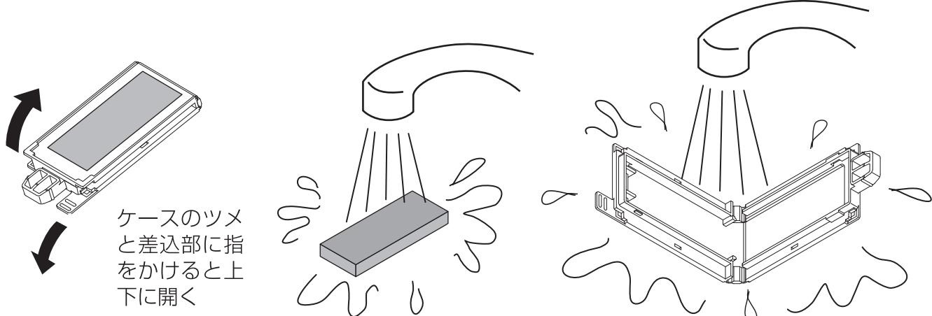
**5** 洗浄が終わったら、マグネシウム合金板をマグネシウム合金板ケースに入れ、ケースをきちんと閉じて、ケースホルダーの差込口にケースの差込部を差し込みます。
