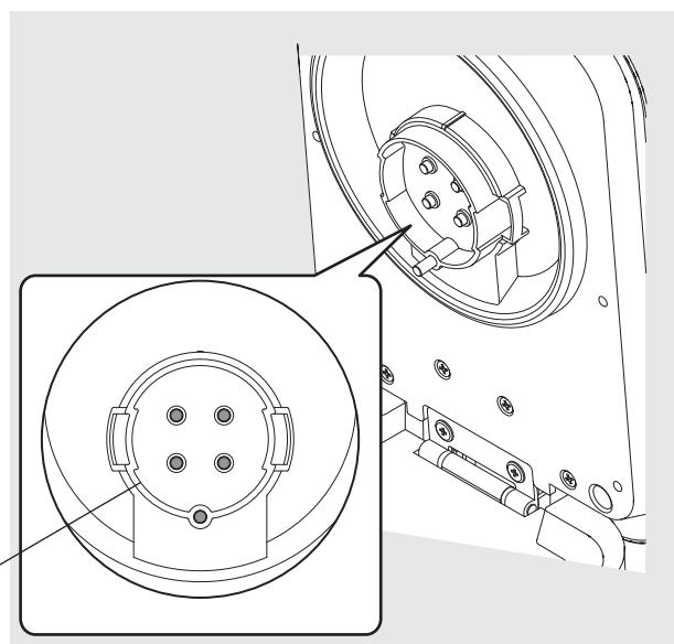
**8** 電極ユニットは必ず乾燥した状態で、お手入れのしかた④マグネシウム合金板(15ページ)を参照して本体に最後まで差し込んでください。
